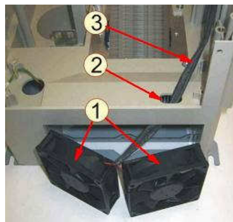
Рис.6.23 1 – вентиляторы; 2 – отверстие в корпусе; 3 – кабели вентиляторов.
